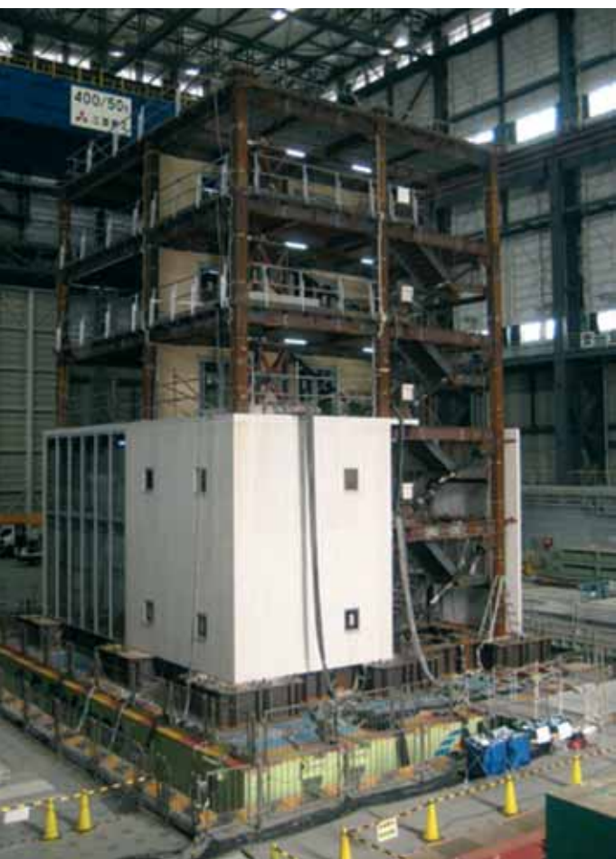
Fig. 28 - Prove su tavole vibrante in scala reale (E-Defence)
