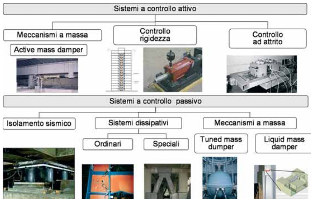
Fig. 12 - Strategie di progettazione antisismica
