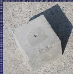
Cubo di calcestruzzo
