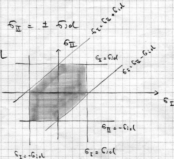
Questo criterio tiene in conto in un punto di 2 delle 3 Tensioni principali
