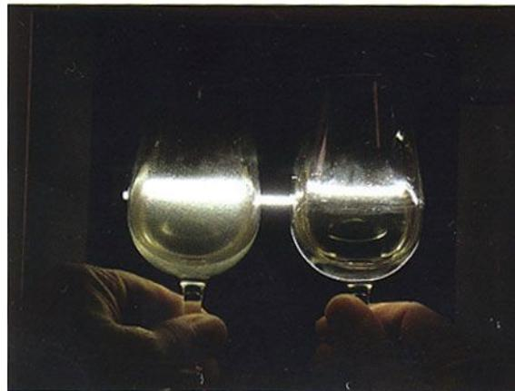
*Osservazione della torbidità tramite l'ENOSCOPE.*
