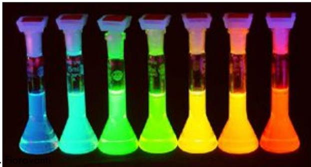
ALTRE, COME IL **SELENURO DI CADMIO (CdSe)**, DIVENTANO **FLUORESCENTI**, EMETTENDO LUCE DI COLORE DIFFERENTE A SECONDA DELLE GRANDEZZA DELLE NANOPARTICELLE.
