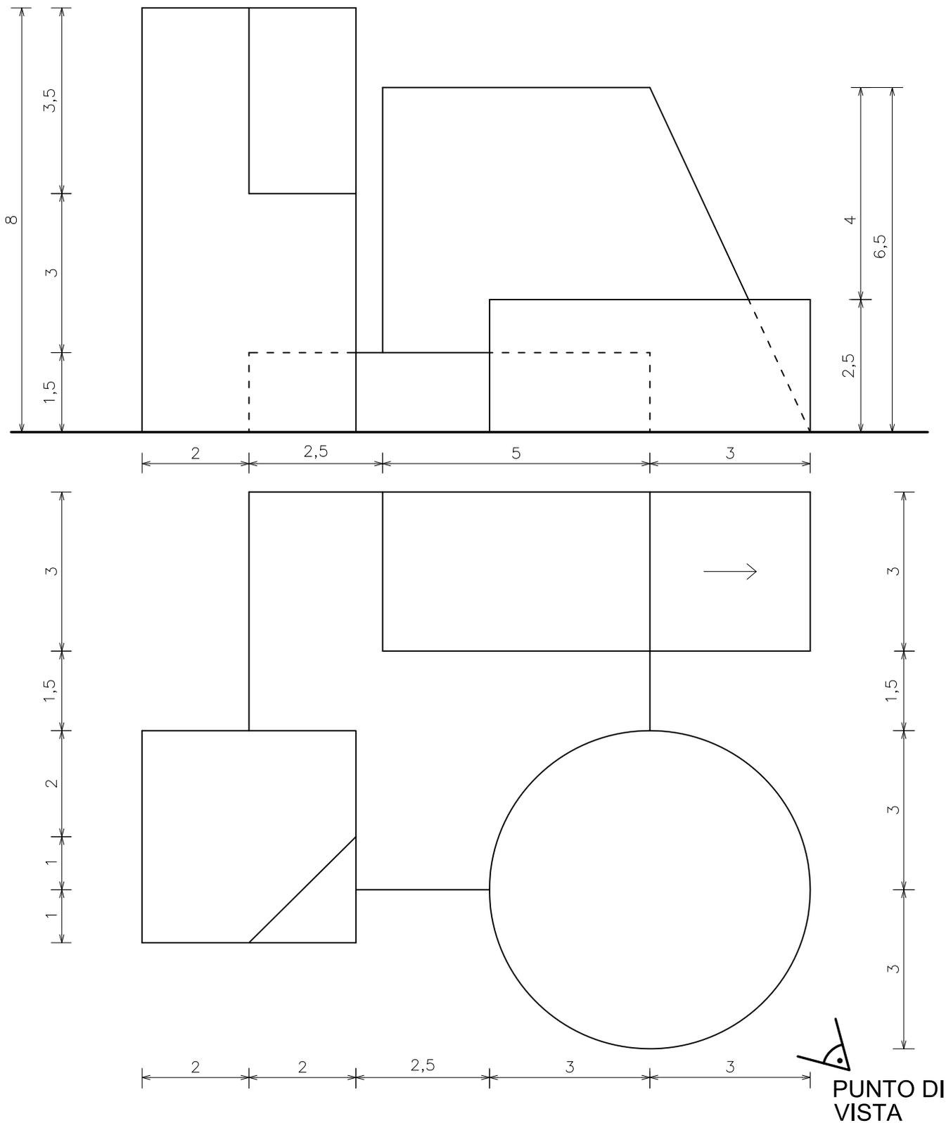
**DISEGNARE L'ASSONOMETRIA ORTOGONALE DIMETRICA DEL SOLIDO DATO**
