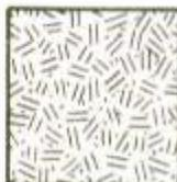
**Scagliatura.** Degradazione che si manifesta col distacco, totale o parziale di parti (*scaglie*) spesso in corrispondenza di soluzioni di continuità del materiale originario. Le scaglie, costituite generalmente da materiale in apparenza inalterato, hanno forma irregolare e spessore consistente e disomogeneo. Al di sotto possono essere presenti *efflorescenze* (v.) o *patine biologiche* (v.).
