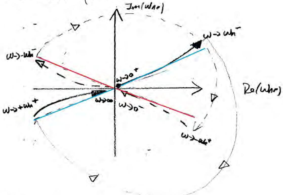
In questo caso particolare le discordanze sulla stabilità di  $W_{CH}(s) = \frac{K W_{AP}(s)}{1 + K W_{AP}(s)}$  mediante il criterio di Nyquist è purtroppo superata, poiché il diagramma polare non presenta intersezioni notabili (diverse dell'origine) con l'asse reale.
