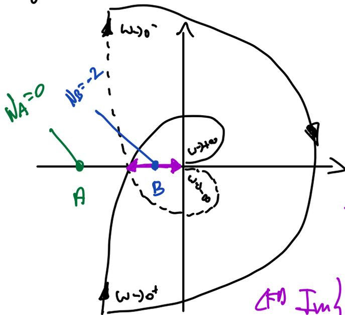
$\leftrightarrow = |KW(j\omega^*)|$  dove  $\omega^*$  è la pulsazione di attraversamento soluzione di  $\text{Im}\{W(j\omega)\} = 0$
