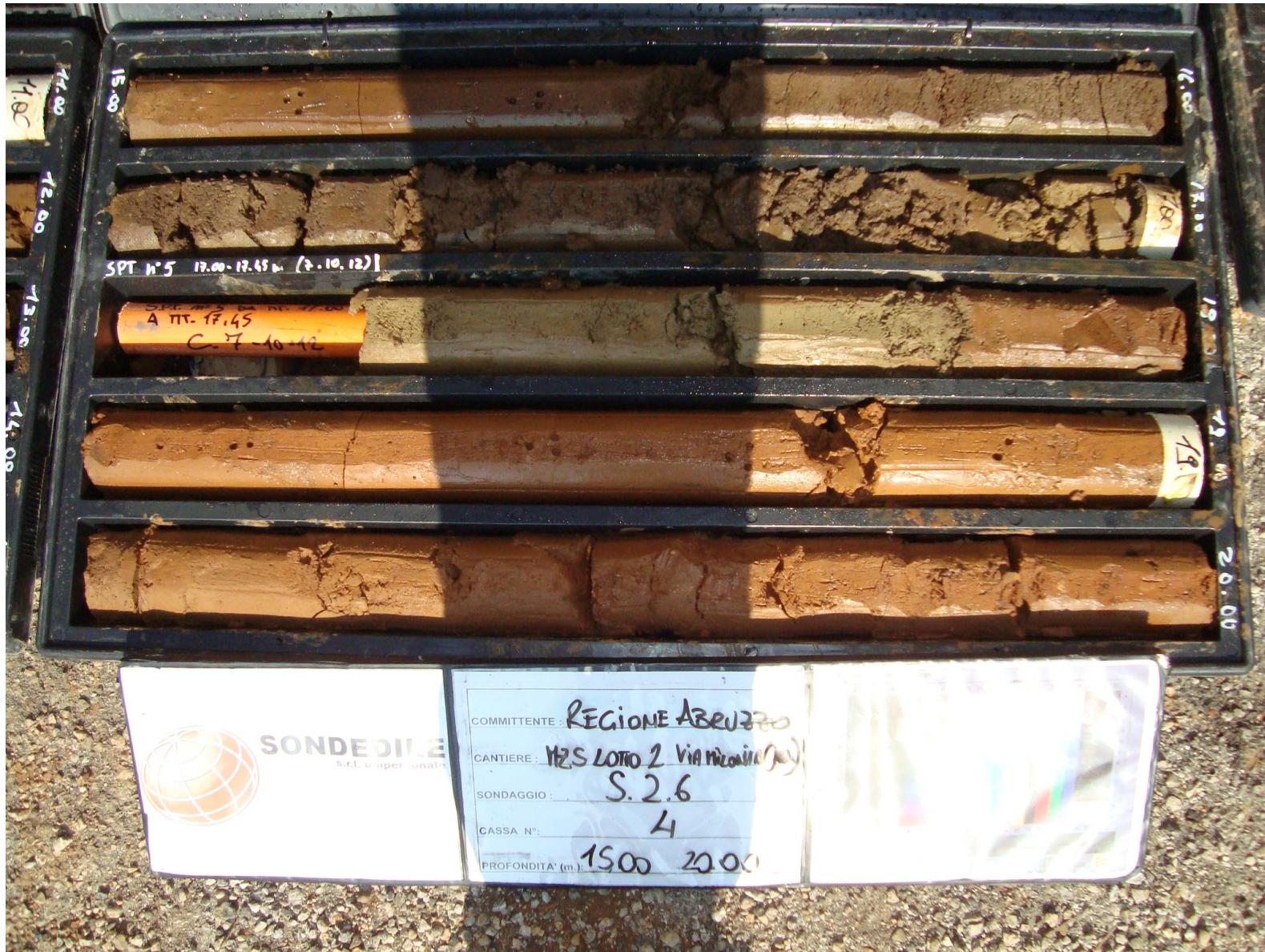
Limi argillosi bruni di Via Milonia (sondaggio S2.6, profondità 15-20 m)
